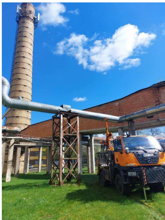
Pav. 5 Gręžimo agregatas tyrimų taške (aut. inž. geol.)
