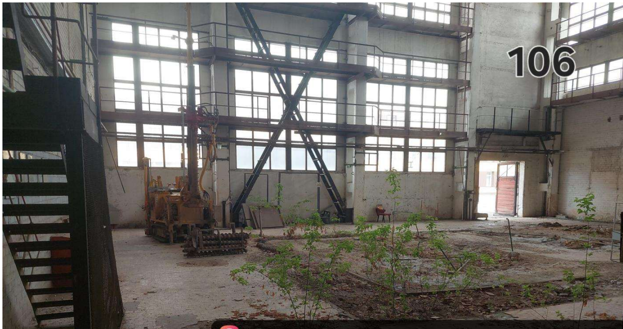
Pav. 8 Gręžimo agregatas tyrimų taške (aut. inž. geol.)
